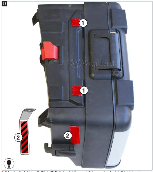
Schneiden Sie 4 gleichgroße Stücke 3M Klett ab und kletten jeweils 2 davon aneinander. Rote Schutzfolie entfernen und auf die markierten Stellen aufkleben (Stellen entfetten). Gepäckplatte positionieren, andrücken und verschrauben.
