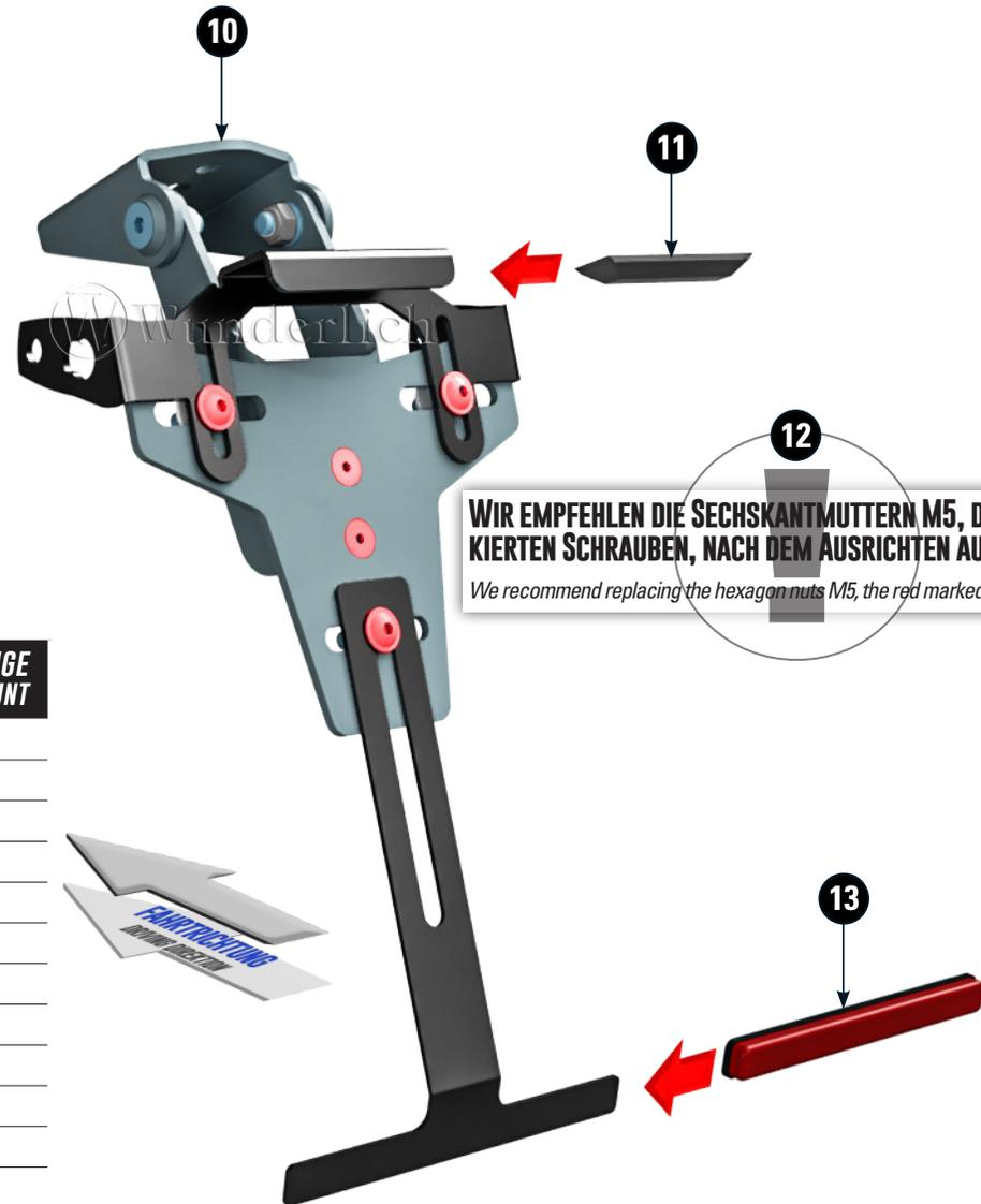
**WIR EMPFEHLEN DIE SECHSKANTMUTTERN M5, DER ROT MARKIERTEN SCHRAUBEN, NACH DEM AUSRICHTEN AUSZUTAUSCHEN!**
