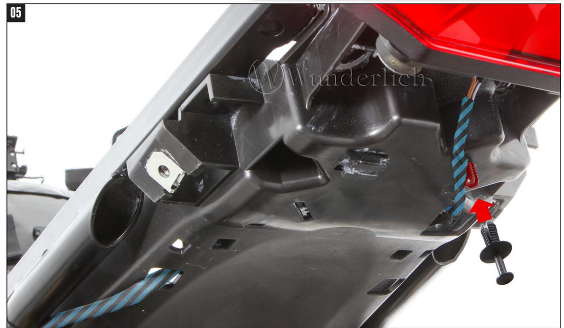
**PVC-DÜBEL ENTFERNEN UND MIT DER FLACHEN SEITE VON UNTEN WIEDER EINSETZEN.**
