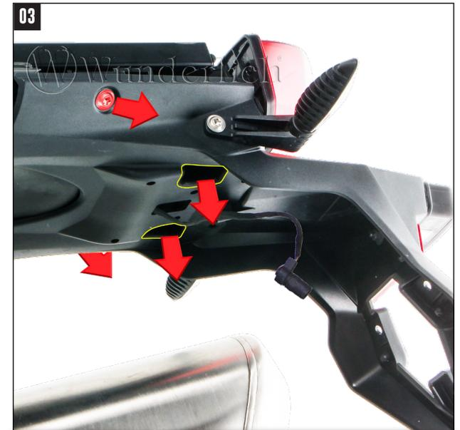
**SCHRAUBEN UND KENNZEICHENBELEUCHTUNG ENTFERNEN**
