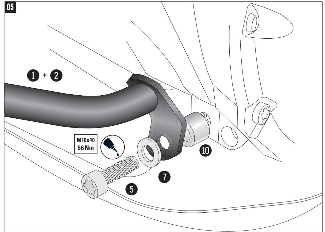
**Montage des Motorschutzbügels vorne unten rechts/links:**
