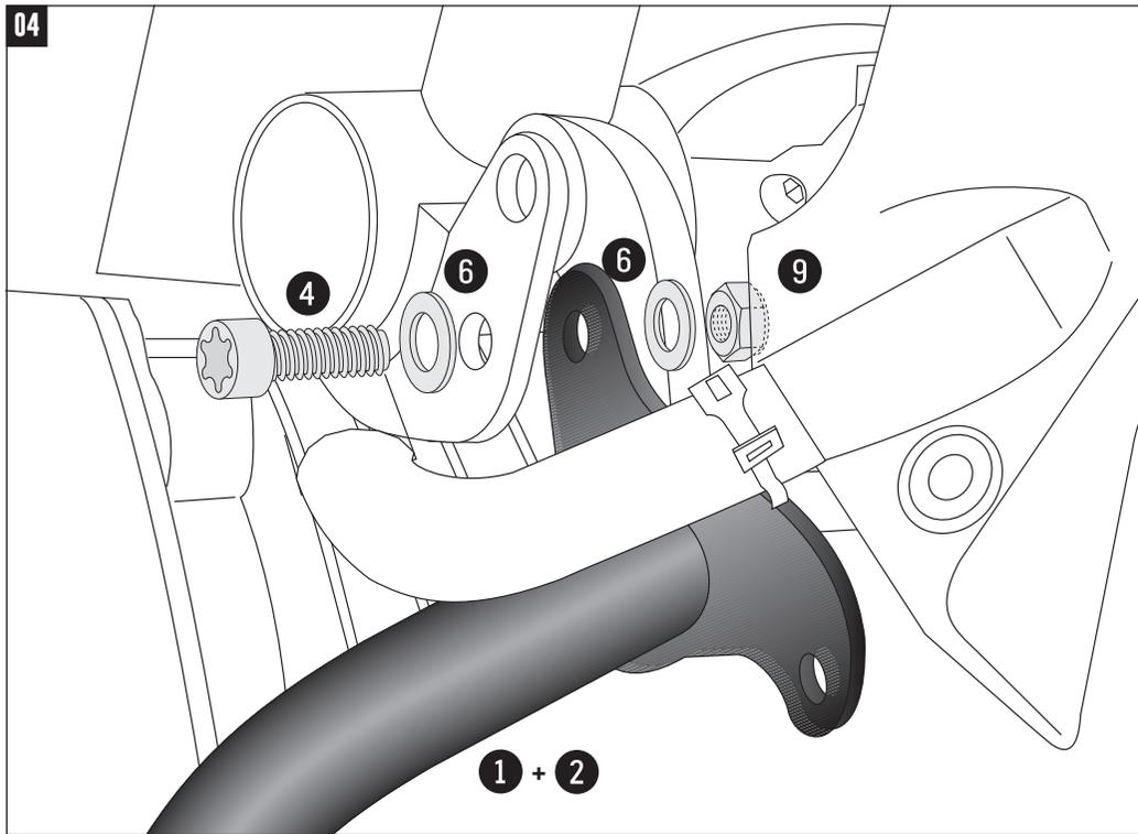
**Montage des Motorschutzbügels oben rechts/links:**
