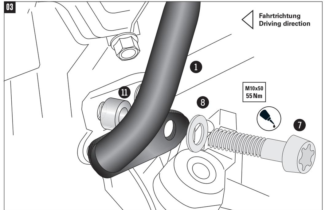
**Montage des Motorschutzbügels hinten links:**
