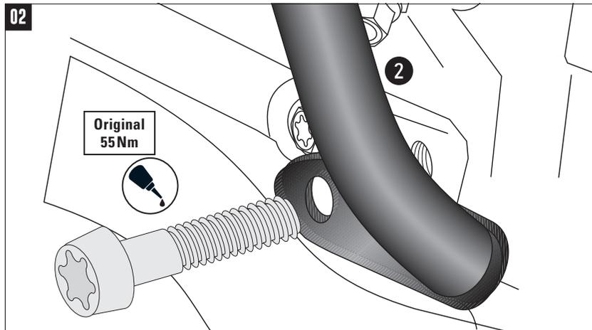
**Montage des Motorschutzbügels hinten rechts:**
