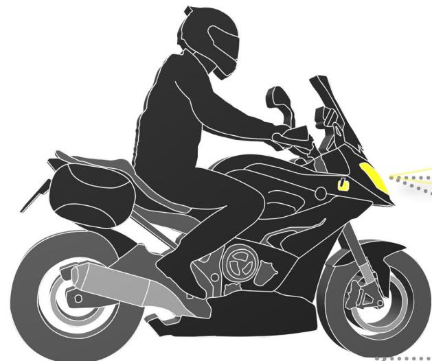
ZUR EINSTELLUNG DER SCHEINWERFER MUSS DAS MOTORRAD MIT DEM FAHRER BELASTET SEIN.
