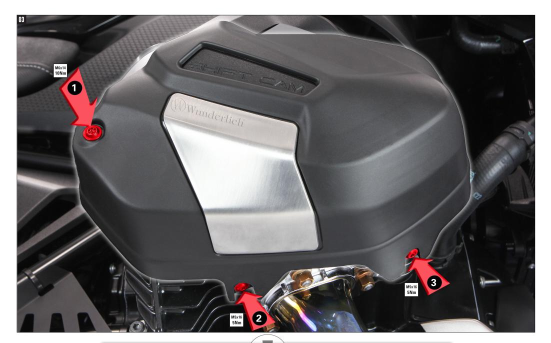
SCHRAUBEN DER REIHE NACH VORMONTIEREN UND DANACH MIT ANGEGEBENEN DREHMOMENT ANZIEHEN.
