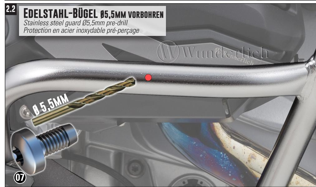
**WIR EMPFEHLEN FÜR DEN ARBEITSSCHRITT „BOHREN“, DEN STURZBÜGEL ZU DEMONTIEREN. IM MONTIERTEM ZUSTAND BOHREN, SCHÜTZEN SIE DEN DAHINTER LIEGENDEN MOTOR BZW. DIE VENTILDECKEL.**
