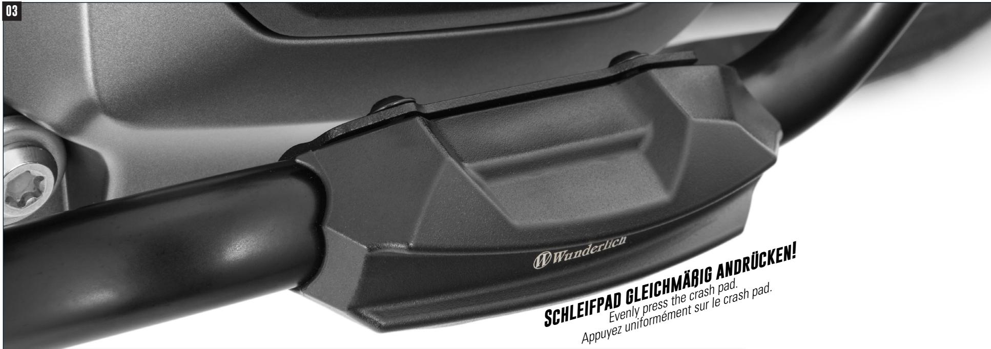
**SCHLEIFPAD VOR DER MONTAGE DES STURZBÜGELS AUSRICHTEN UND VERSCHRAUBEN. IST DER STURZBÜGEL SCHON MONTIERT, DIESEN ETWAS LÖSEN!**
