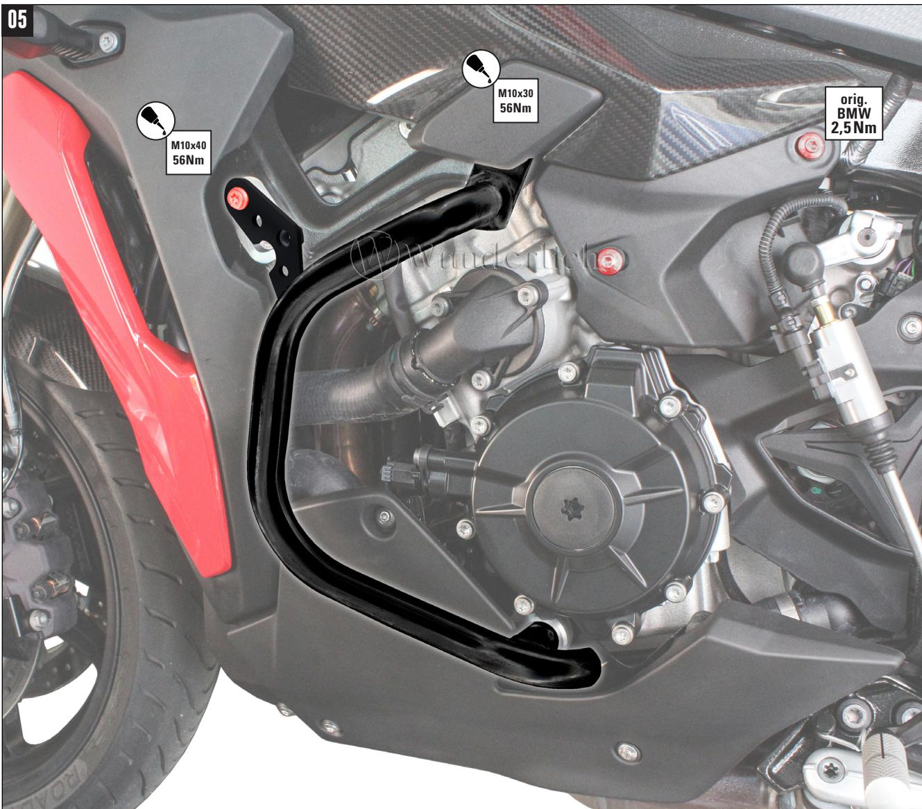
**VORDEREN BEFESTIGUNGSPUNKT MONTIEREN UND BEIDE MIT DEM ANGEgebenEN DREHMOMENT ANZIEHEN. SEITENVERKLEIDUNG IN UMGEGEHRTER REIHENFOLGE BEFESTIGEN.**
