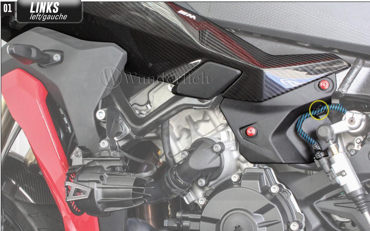
**MARKIERTE SCHRAUBEN HERAUSDREHEN UND DAS SCHRAFFIERTE KABEL (SCHALTASSISTENT) AUS DER KABELFÜHRUNG ZIEHEN.**
