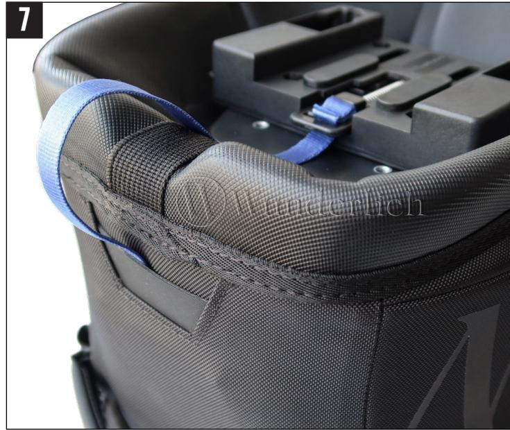
Das Zugband befindet sich im Tankrucksack. Zur Verlegung bzw. Durchführung, entfernen Sie den Clip, dieser wird nach der Banddurchführung wieder eingefädelt.
