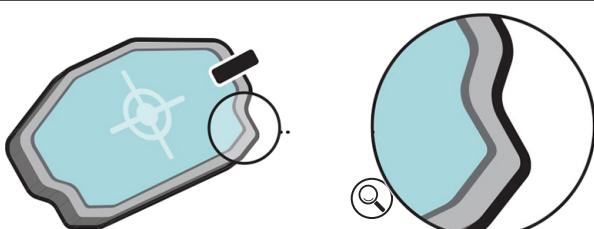
Schutzfolie am Display ausmitteln. Beachten Sie, dass der Umriss bei den meisten unserer Schutzfolien absichtlich etwas kleiner gewählt wurde. Dadurch wird die Schutzfolie an der äussersten Kante nicht angehoben
