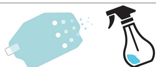
Die in Schritt 3 freigelegte untere Seite der Displayschutzfolie großzügig mit Spülmittelwasser besprühen
