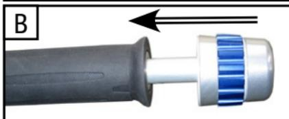
Bitte achten Sie darauf, daß das Lenkerendgewicht (CruiseControl) mit Abstand zum Gasgriff montiert wird (Bild C), der Gasgriff muß sich nach der Montage der Lenkerendgewichte freigängig drehen lassen.
